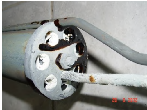
Depósitos de minerales en un electrodo permanentemente dañado por falta de limpieza con ácido
